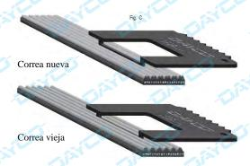
El control final de las grietas permite que el técnico vea las gargantas de la correa mediante la "ventana" de un cuadrado de 25 mm. Si a través de la ventana se ven cuatro o más grietas se aconseja sustituir la correa antes de que se desprenda del todo.
