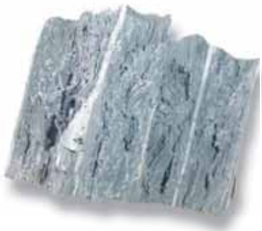
Fig. 4 - Son evidentes las deformaciones de los canales debidos a locales acumulaciones de calor engendrados por las oclusiones reincidentes.
